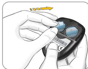
4. 將新電池按壓彈簧插腳放入電池槽中，有「+」的一頭朝上。[使用兩顆 3 伏特（DL2032 或 CR2032）鋰電池。]
